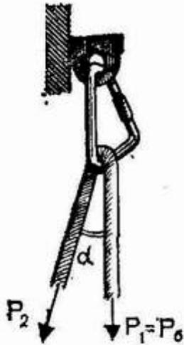
Рис. 12. Схема нагружения верхнего крюка
